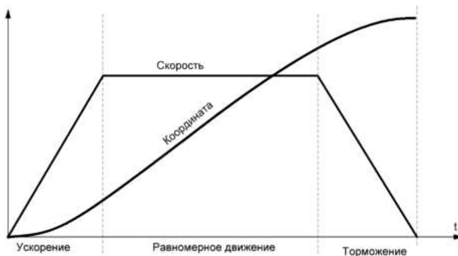
Рис. 5 – Движение от точки к точке с заданной скоростью и ускорением
