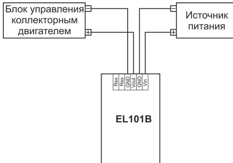
Рисунок 3 – Схемы подключения модуля защиты
