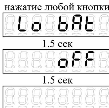
Рисунок 2 - Индикация разряженных аккумуляторов.
