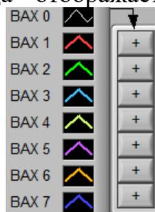
Нажатие на кнопку справа ВАХ1...ВАХ7 копирует текущую ВАХ 0 в соответствующий график. Таким образом можно построить семейство ВАХ для сварочного источника.
