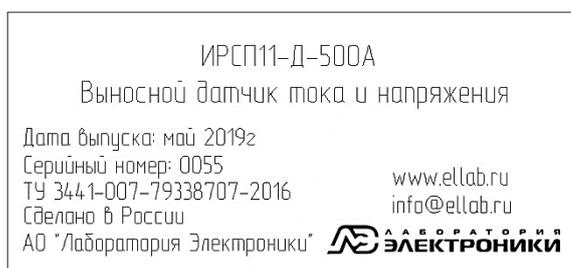
*Рисунок 6 – Маркировка выносного датчика тока и напряжения*
