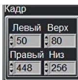
В «Кадр» задаются размеры отображаемого в поле кадра. Для ускорения работы программы можно не отображать весь кадр, а только область определения линии лазером.
